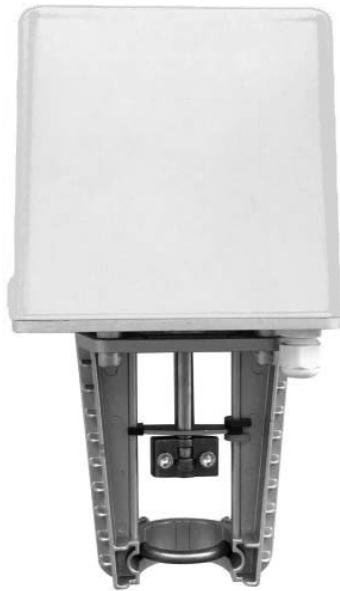
Электропривод AMV(E)-3000R предназначен для управления регулирующими клапанами Ридан VFM-2R DN 100–200 и VF-3R 100–150; VFS-2R DN 100–20, VF-2R DN 100–200. Управление приводом Ридан AMV-3000R осуществляется по импульсному сигналу от электронных регуляторов Ридан типа ECL-3R/4R или подобных.
